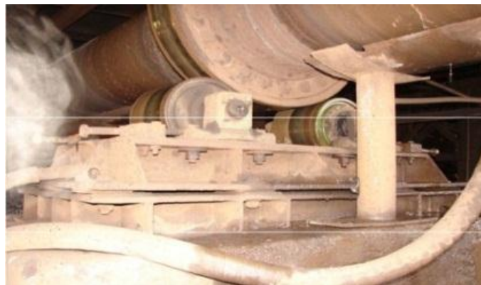
Figura 2.1. Ubicación de los rodillos radiales del transportador sinfín.
