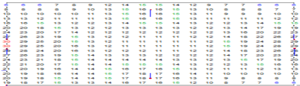
Figura 3. Distribución de los lux que llegan a la calzada.
